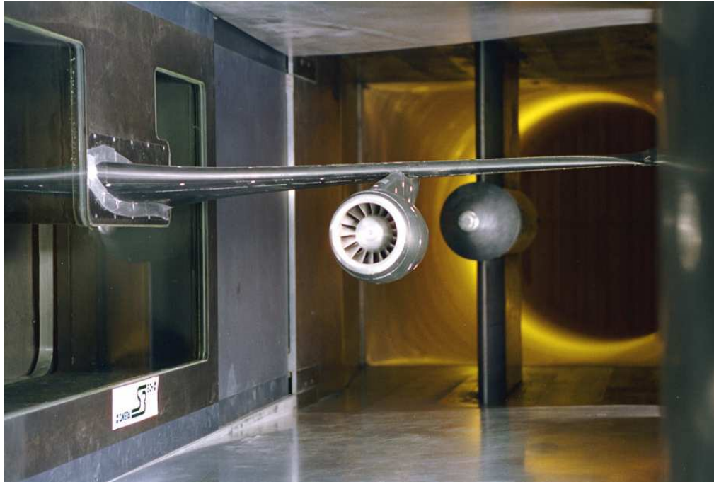
Veine de la soufflerie S3Ch avec maquette motorisée d'aile d'A340
