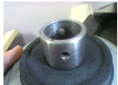
perçage sur l'axe de l'hélice
