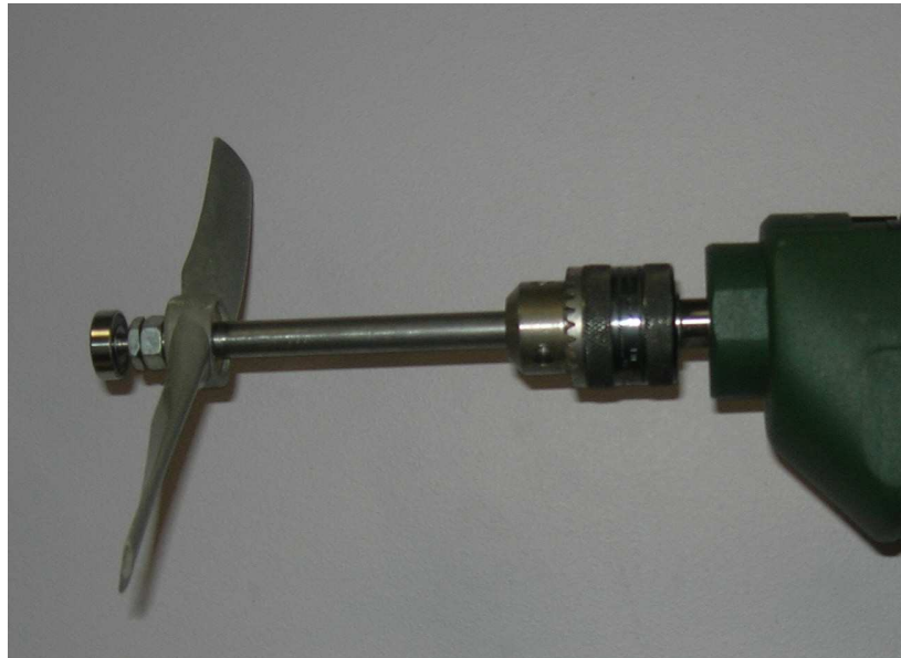
Axe de l'hélice fixé sur le mandrin de la perceuse
