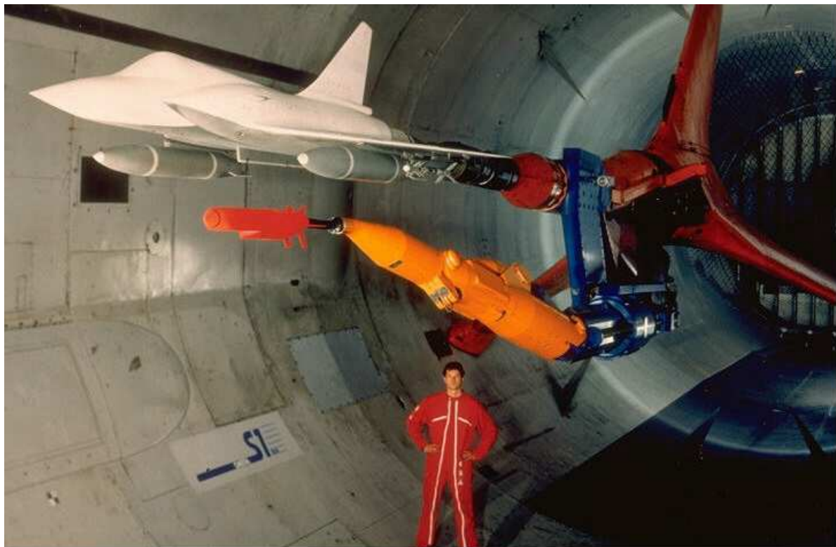
Essai de largage d'un missile Apache sous Mirage 2000 dans la soufflerie S1MA
