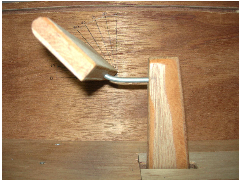
Profil d'aile fixé à 45° sur le support
