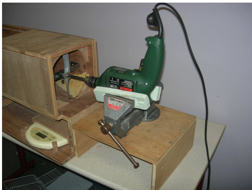
Perceuse fixée sur l'étau en position de fonctionnement
