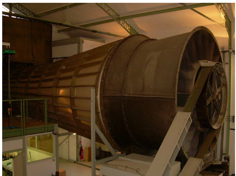
ventilateur de la soufflerie relié au moteur par une courroie
